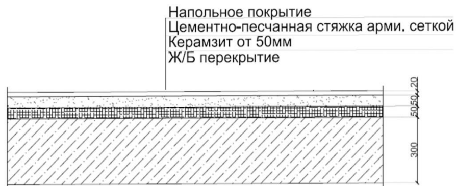
Рисунок 62. Узел: конструкция междуэтажного перекрытия с укладкой пола (чертёж автора).
