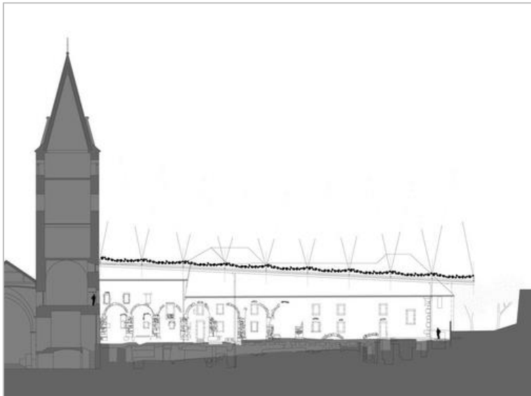
Рисунок 10-11. Навес над археологическими раскопками Аббатства Сен-Морис – разрез, фрагмент навеса. [22]
